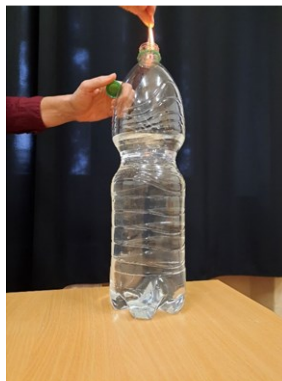
1. ábra: A gyufa eloltásánál koromszemcsék kerülnek a víz fölötti térbe.
